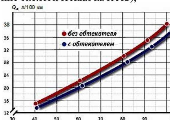
Рисунок 3 – Топливная характеристика автомобилей: а – КАМАЗ-4325; б – ГАЗ-17310В «Трофим»
