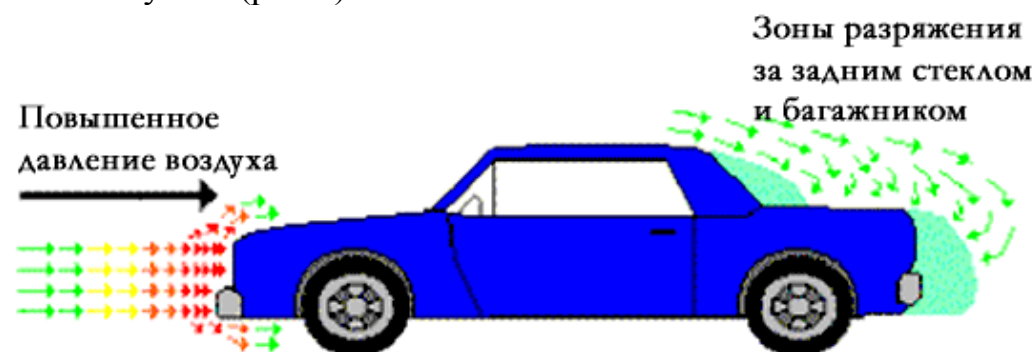
Рисунок 1 – Перемещение воздуха при движении автомобиля
