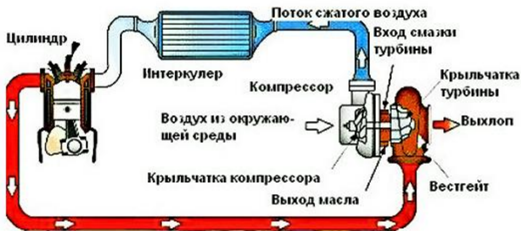
Рисунок 1 – Схема работы турбокомпрессора
